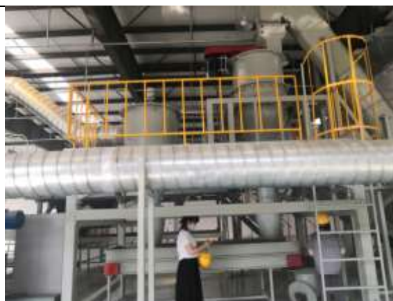
气流分选系统（泡棉破碎分级机）
